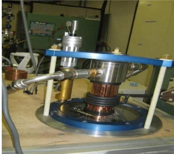
Figure I-13: Four haute température utilisé pour la réalisation des échantillons massifs [20].
