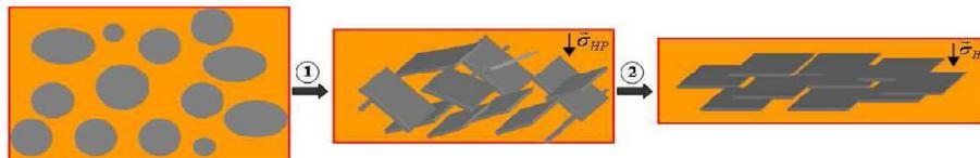
Figure I-16: Pressage à chaud des céramiques : (1) densification et transformation en lamelles 'plaquettes', (2) alignement des plaquettes suivant l'axe du pressage.
