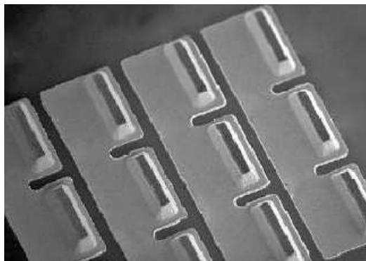
Figure I-10-b : photo de MEB d'un module en couches minces [18].
