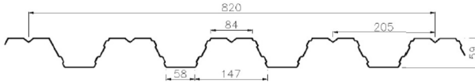
Figure IV.12 : Pontage métallique type HAIRCOL59
