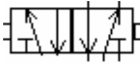
Figure I.5 : symbole de distributeur 5/2
