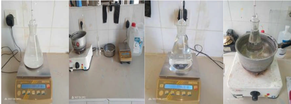
Figure 3: Mode opératoire de l'essai au pycnomètre.
