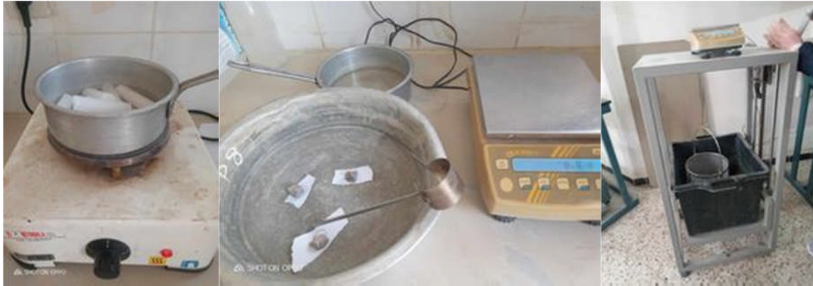
Figure 4: Mode opératoire de la pesée hydrostatique.
