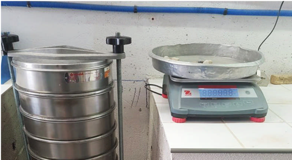
Figure III. 1: Analyse granulométrique par voie sèche à l'aide d'une tamiseuse.
