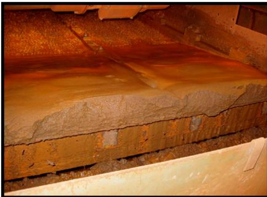
**Figure 100:** Photo montrant essorage de la barytine flottée.
