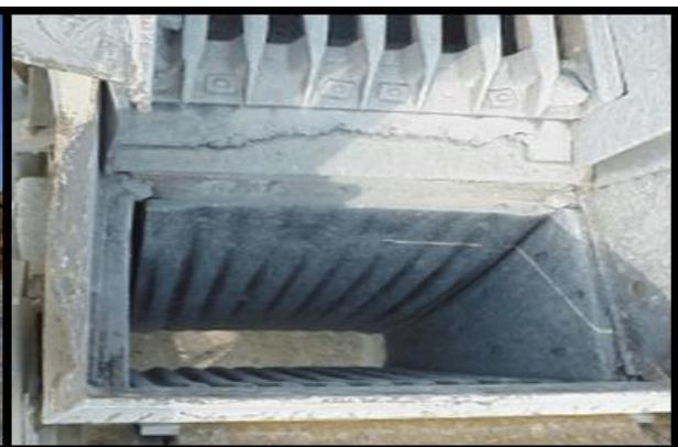
**Figure 98:** Photo montrant un concasseur à mâchoires.
