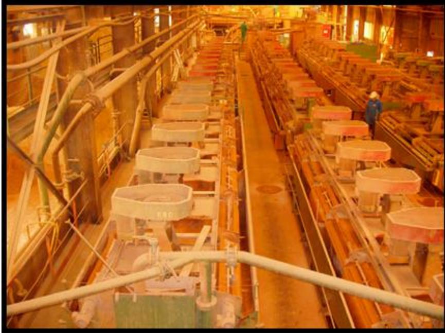
**Figure 99:** Photo montrant la batterie de cellules de flottation.
