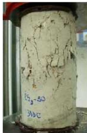
Béton CS3-30 après cycle de chauffage-refroidissement de 300°C.
