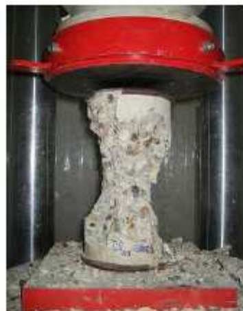
Béton CP3-2 après cycle de chauffage-refroidissement de 300°C.
