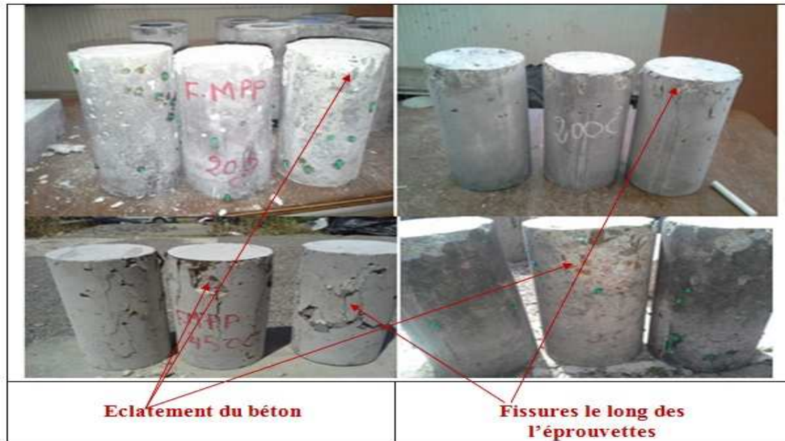
Figure V.16: Rupture des éprouvettes cylindriques sous sollicitation de compression.
