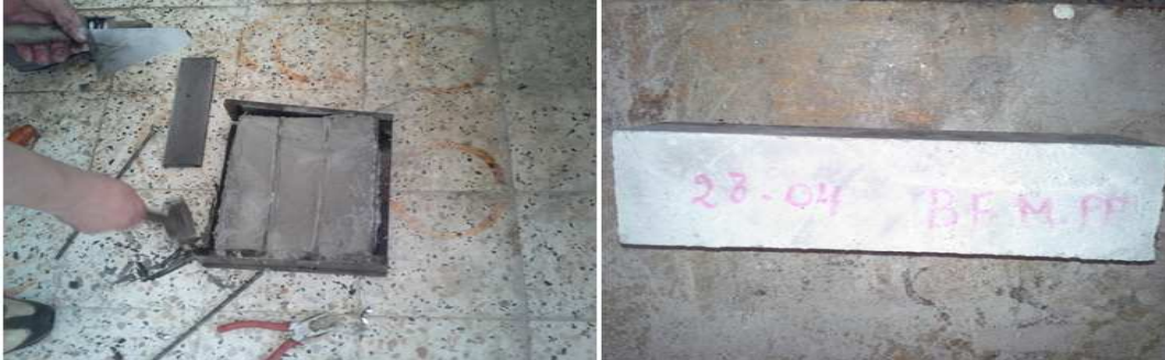
Figure IV.24: Démoulage de l'éprouvette prismatique.
