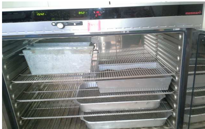
Figure IV.2: Séchage des granulats.
