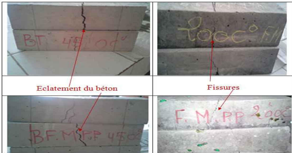
Figure V.29: Éprouvette prismatique après écrasement.
