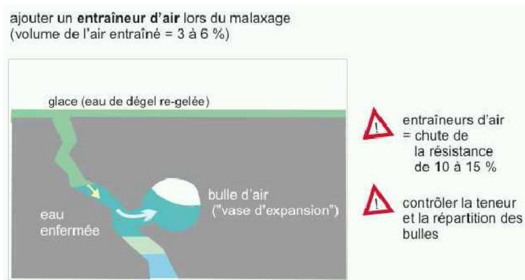
Figure I.8: Ajout d'entraîneur d'air lors du malaxage [ 5].
