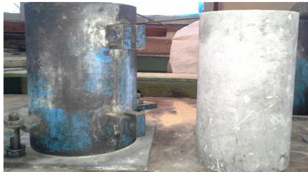
Figure IV.25: Démoulage de l'éprouvette cylindrique.
