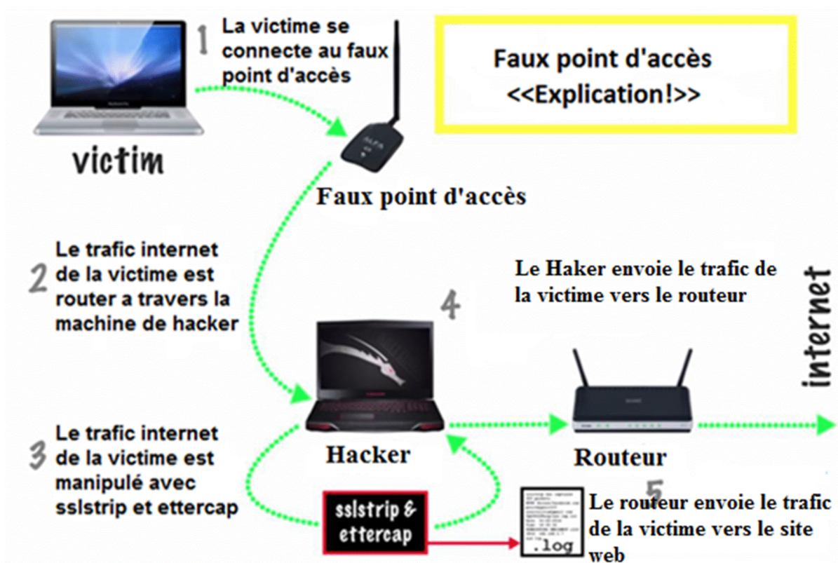
Figure 25 : Représentation schématique de procédure du faux point d'accès [15].
