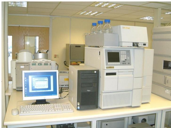
**Figure 14: HPLC water utilise équipé du logiciel Empower 3**
