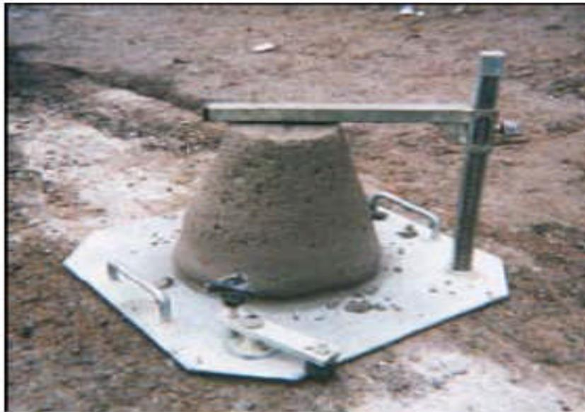
Figure 2-6 : Essai au cône d'Abrams.
