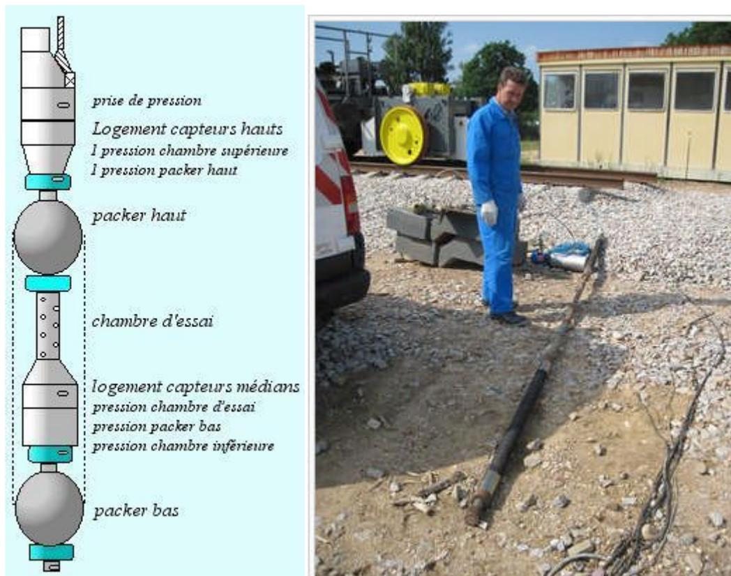
Figure 3-1 : Schéma de la sonde Lugeon
