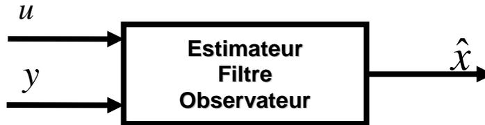
Figure II.1 : Schéma synoptique du filtre de Kalman.
