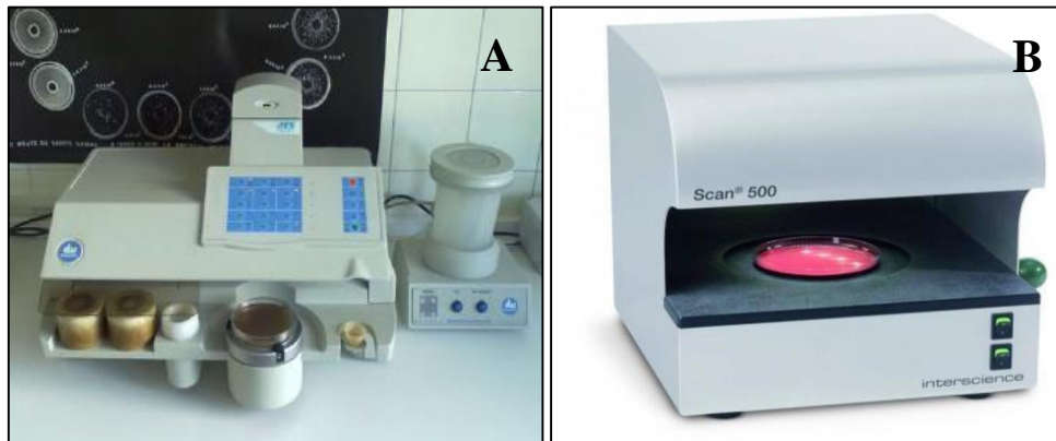
Figure 16 : A : Encemenceur spiral (Don Whitley Sci. Ltd., Royaume-Uni) B : Compteur de colonies automatique Scan 500 (Interscience, France)
