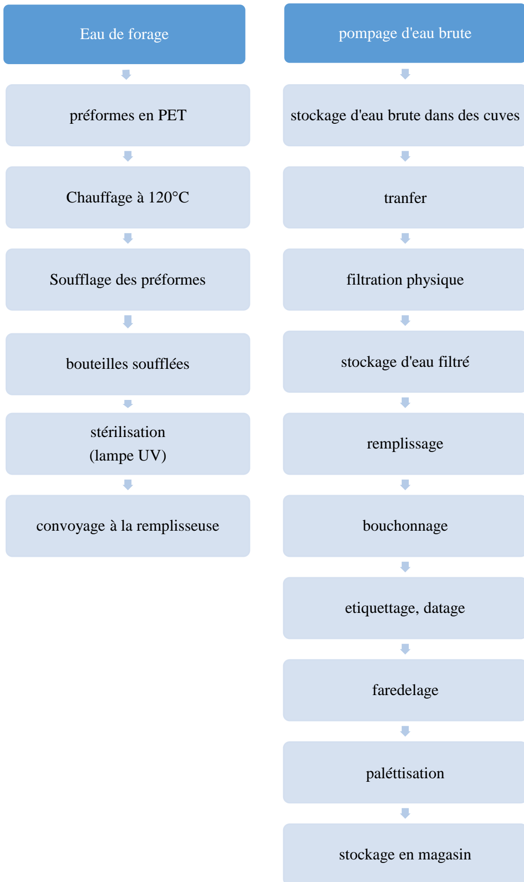
Figure 11 : Processus d'embouteillage de l'eau minérale en emballage PET (Medjkoune et Allou, 2019)
