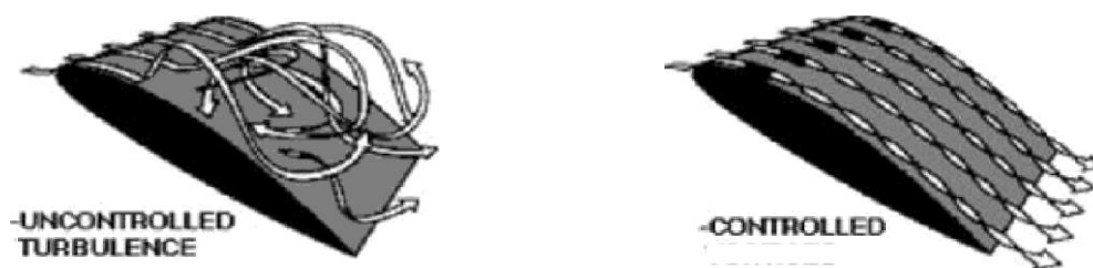
Figure III. 21 Contr  le de la vorticit   gr  ce    des riblets ou des syst  mes LEBU. [20]
