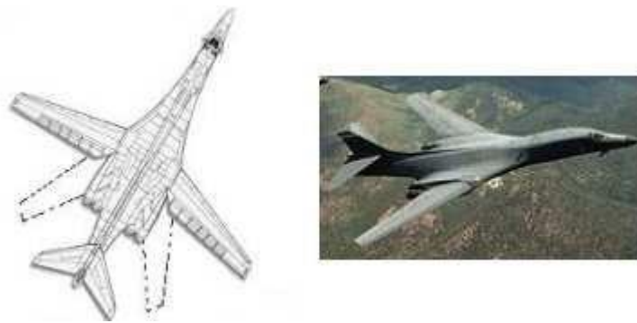
Figure I.24 L'aile à géométrie variable exemple Rockwell B-1 Lancer [2].
