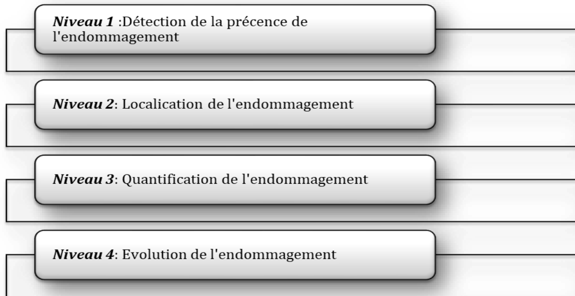
Figure 4 : schéma des 4 niveaux de détection des endommagements
