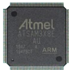
FIGURE 3.3 – Le Microcontrôleur Atmel SAM3X.
