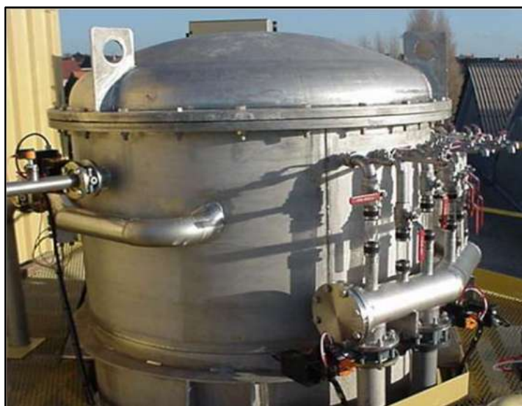
Figure II.1 : Vue générale d'un filtre EXOFALC.
