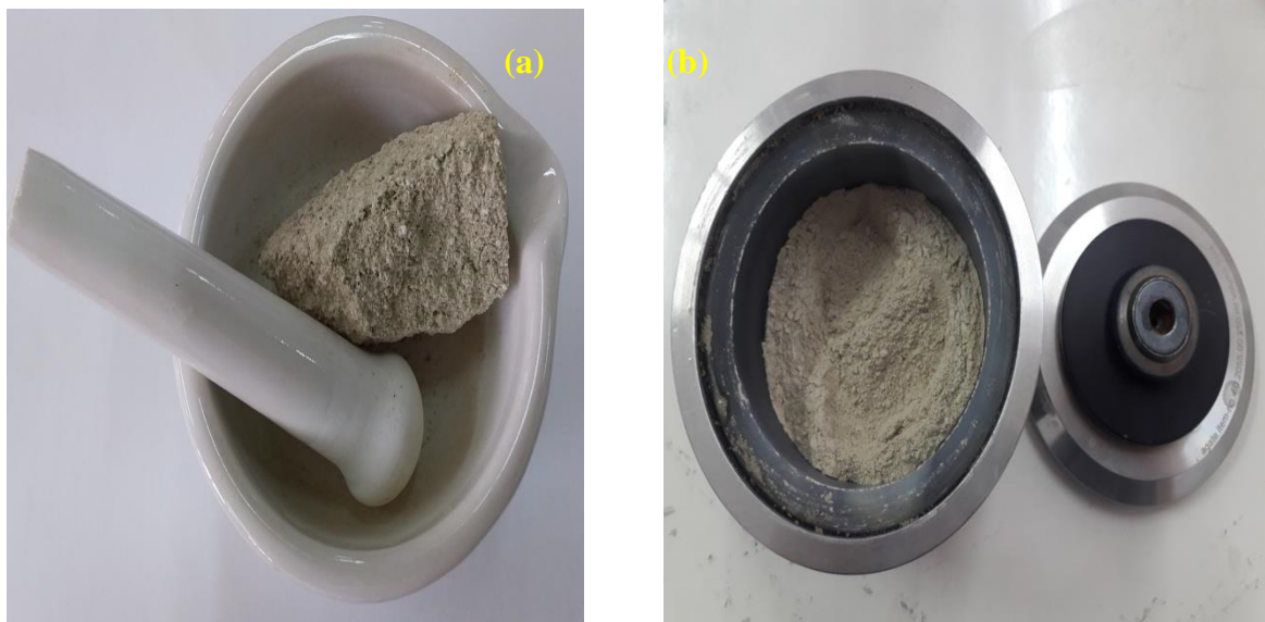
Figure II.4. (a) Produit initial et (b) Initiation du broyage fin
