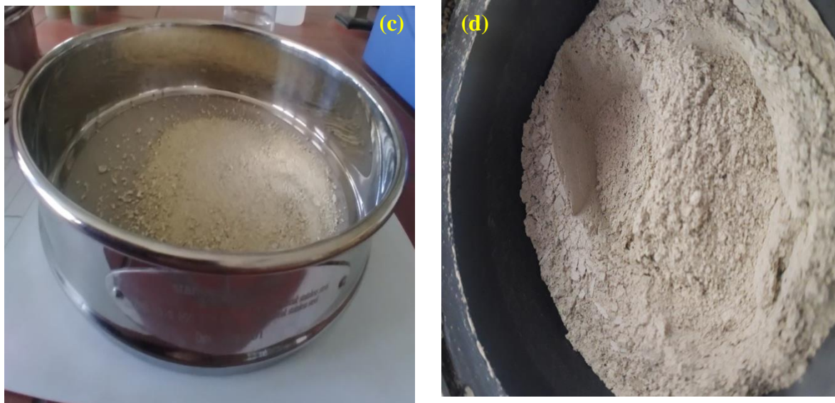
Figure II.4 (c) Tamisage (0.02mm) et (d) Produit final
