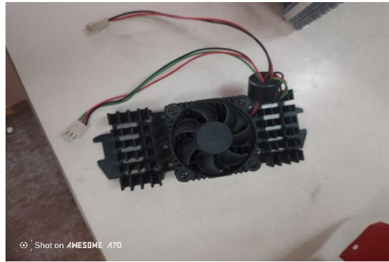
Figure IV.3 : Dissipateur pour la résistance
