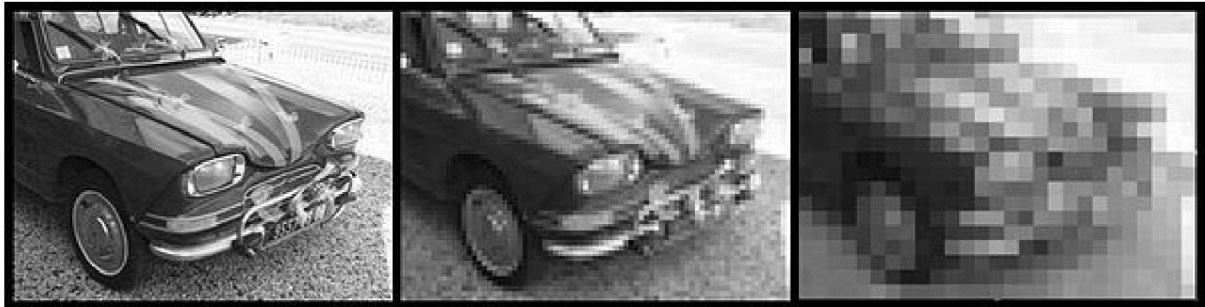
Figure I.2 : exemple de résolution d'une image
