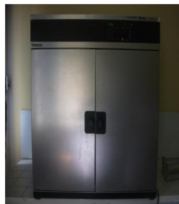
Figure 26 : L'Etuve Pasteur à 121°C.
