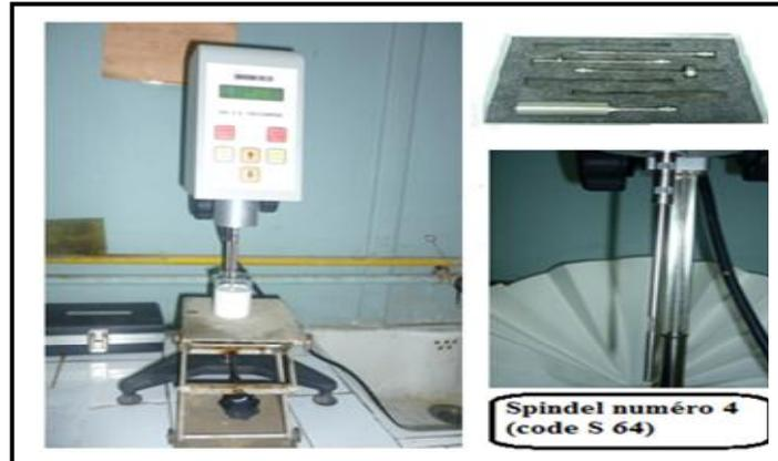
*Figure 38*): viscosimètre de type **BROOKFIELD** et les différents types de spindel.
