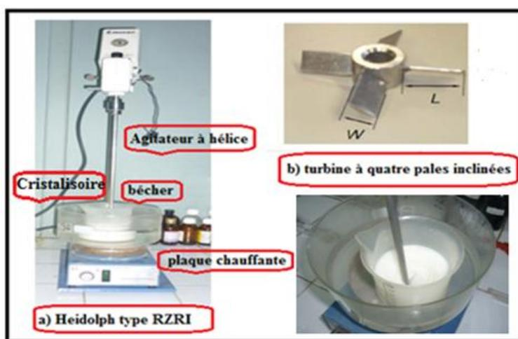
*Figure 34*) : Dispositifs de procédé : a) Heidolph type RZR. b) Turbine à quatre . pales inclinées.
