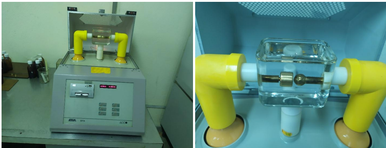
Figure III.7: Générateur haute tension utilisé pour les essais de rigidité dielectrique.
