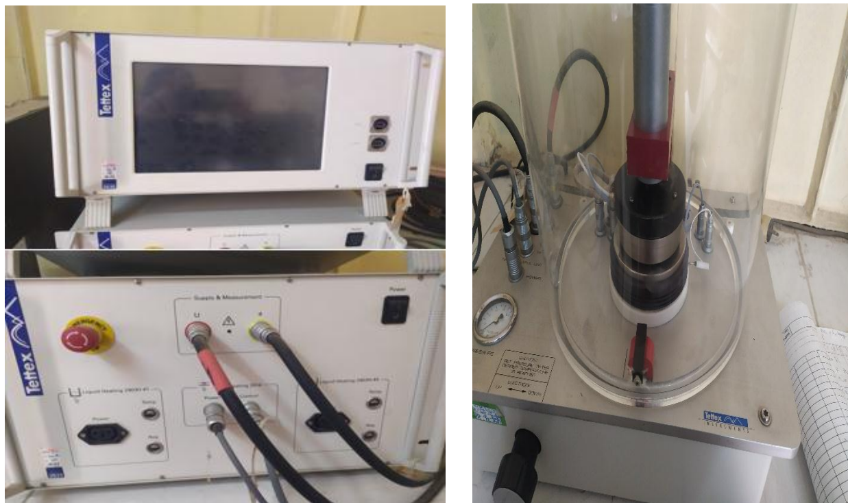
Figure III.5 : Pont de Schering utilisé pour les essais diélectriques.
