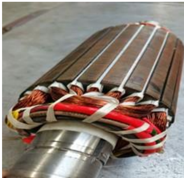
Figure IV-6: représente le rotor bobiné
