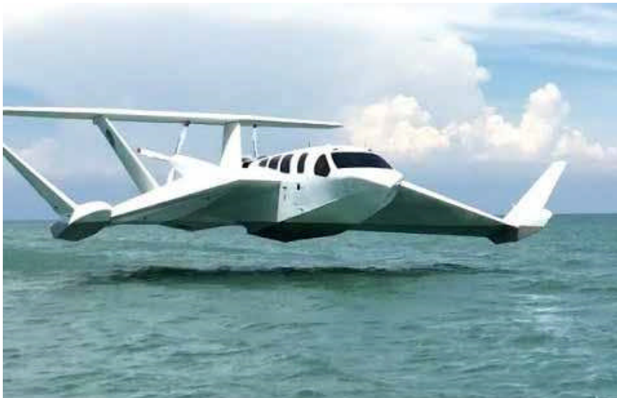
Figure I 23 : air-Fish véhicule à effet de sol mi bateau mi avion [6]
