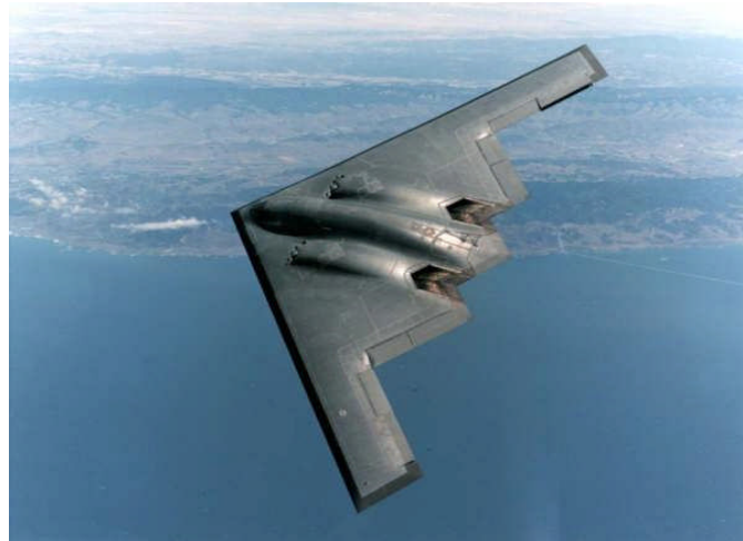
Figure I.2 : Le B2 étant une aile delta simple [28]
