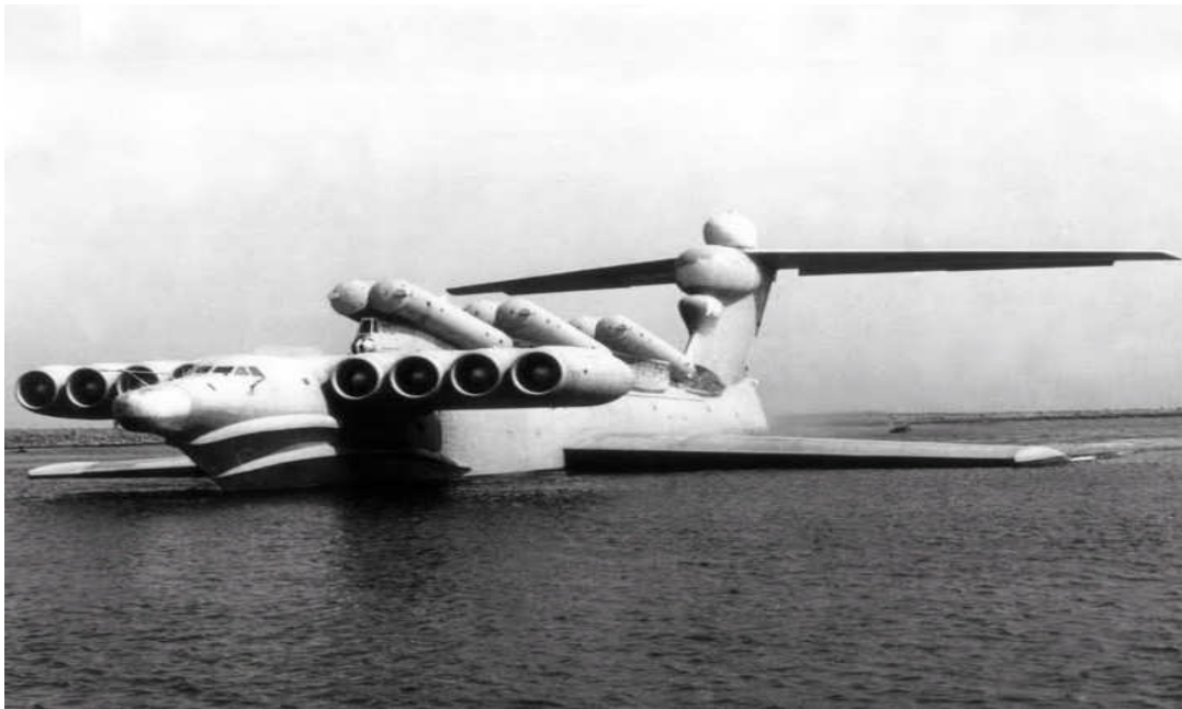
Figure I.21 : Avion Soviétiques à effet de sol Ekranoplan [6]
