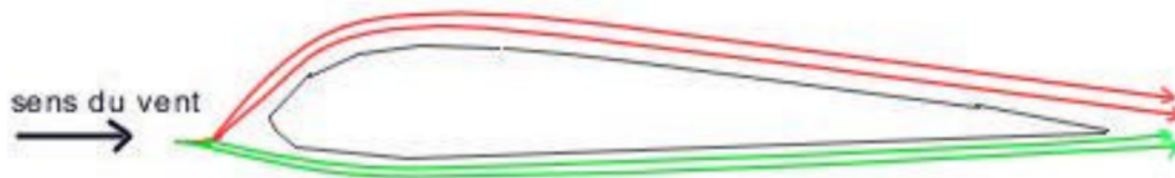
Figure I.8 : vitesse de l'air sur un profil d'aile
