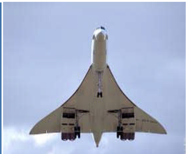
Figure I.4 : Le Concorde équipé d'une aile tronquée Gothique[28]
