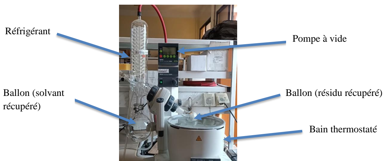
Figure 2.1: Montage du rot à vapeur
