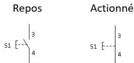
Figure II.21 : Bouton poussoir normalement ouvert
