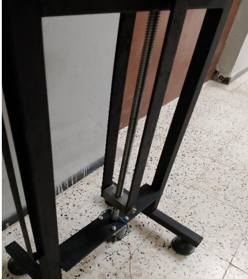
Figure III.28: photo illustrant le mécanisme utilisé pour régler la hauteur
