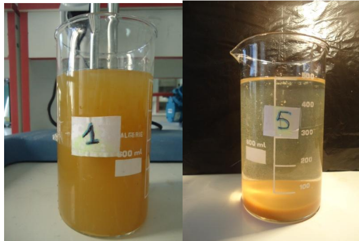
Figure III.8 : La nature de l'effluent avant et après traitement
