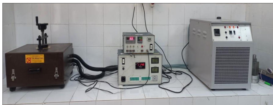
Figure III.15. Dispositif de mesure de la conductivité thermique
