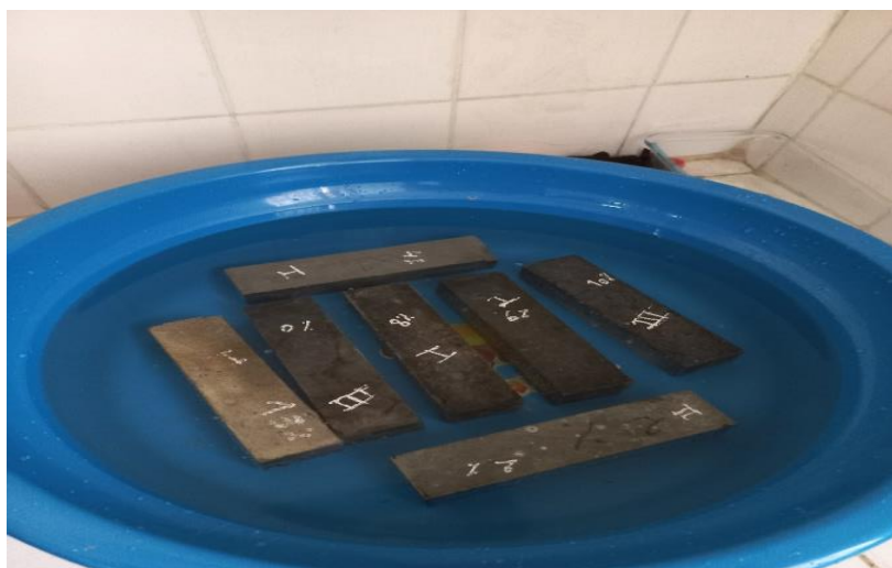
Figure III.10. Essai d'immersion totale dans l'eau des composites Bois-Ciment
