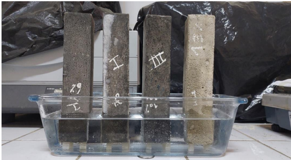
Figure III.9. Essai d'absorption par capillarité des composites Bois-Ciment
