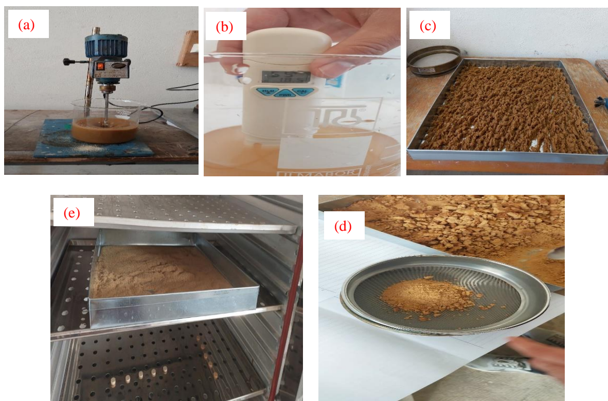
Figure III.3. Procédure du traitement alcalin avec NaOH (5%). (a) : L'agitation de l'ensemble sciure du bois et solution NaOH (5%). (b) : Contrôle du PH avec un PH-mètre. (c) : Filtrage de la farine du bois. (d) : Farine du bois traitée après étuvage à 100°C
