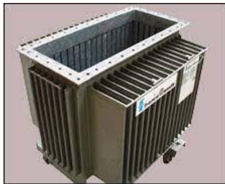
Figure 3.11. Cuve d'un transformateur.
