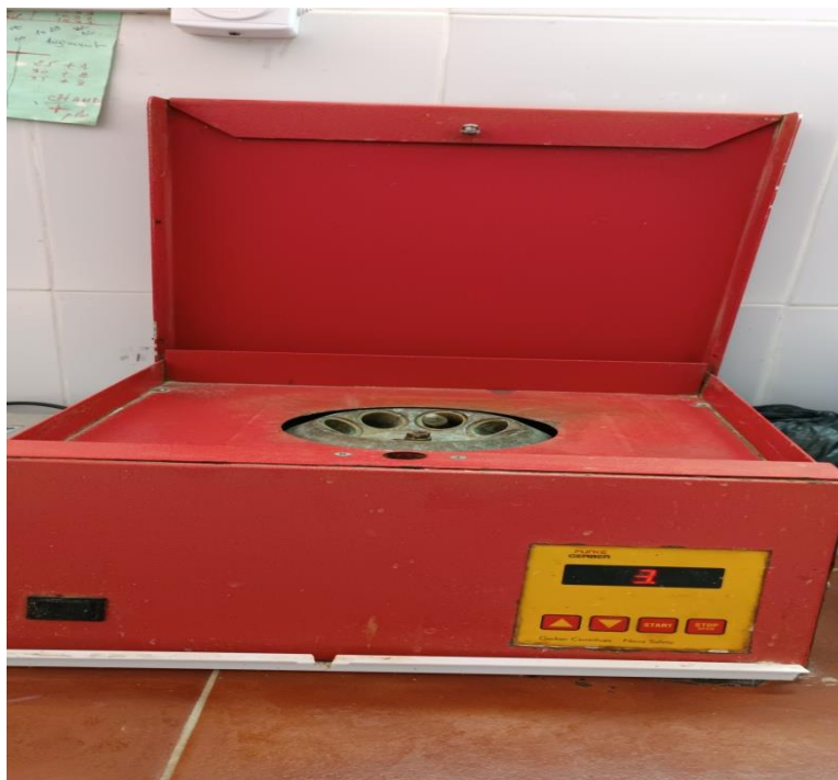
Figure 16 : Centrifugeuse Gerber pour la détermination de matière grasse du lait (Freha, 2022).
