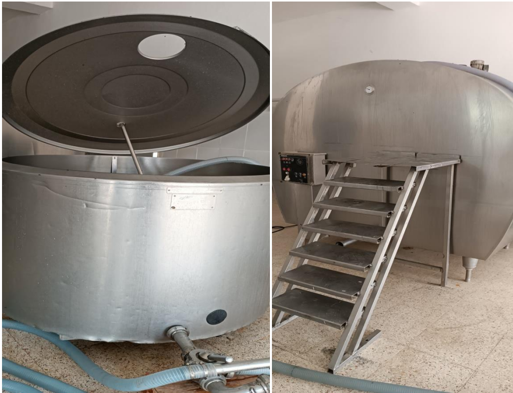
Figure 08 : Cuve de refroidissement.
