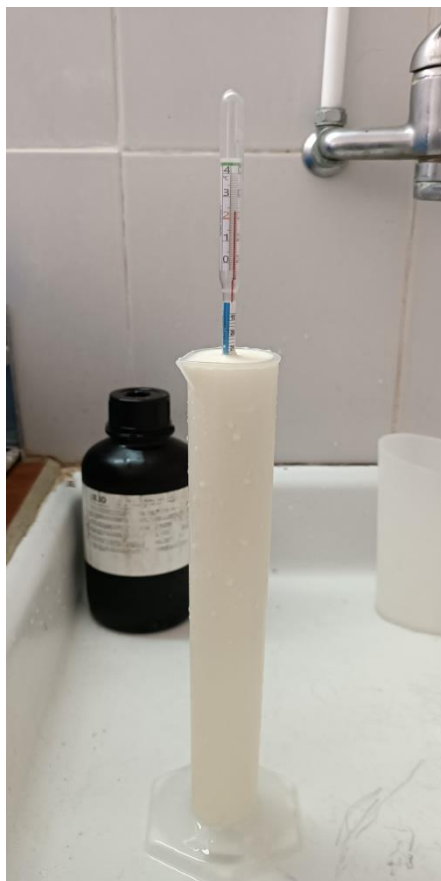
Figure 14 : Détermination de la densité du lait par un lactodensimètre (Freha, 2022).
