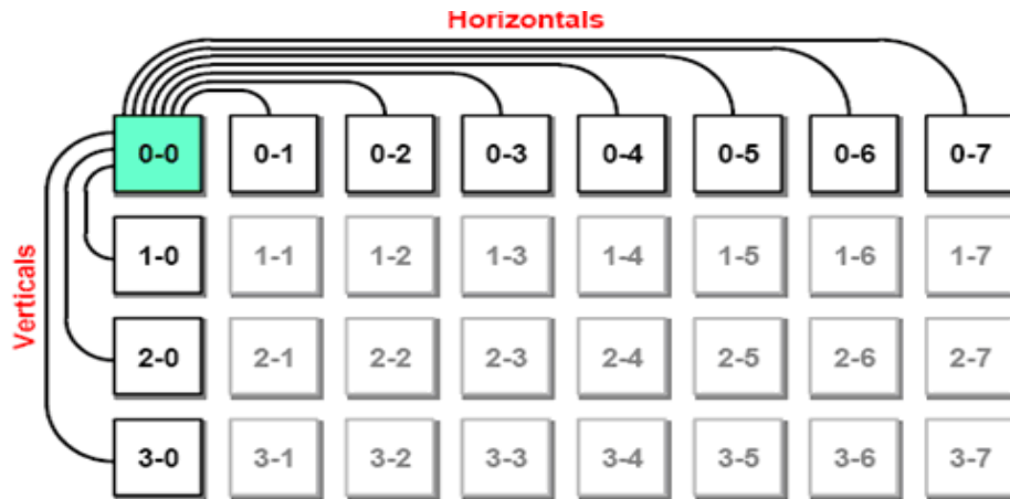
Figure III-19- Le câblage Horizontal et vertical
