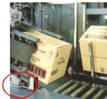
Figure18 : exemple d'utilisation d'un capteur TOR
