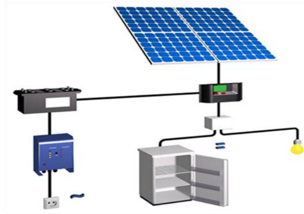
Figure II.1 : schéma d'un system autonome [14]
