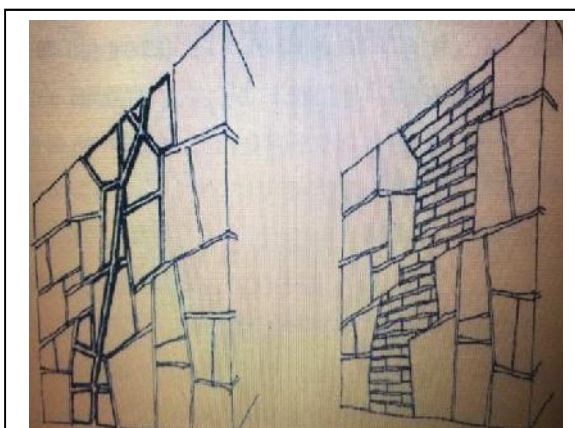
Figure 5-8: reprise des fissures sur un mur en maçonnerie
