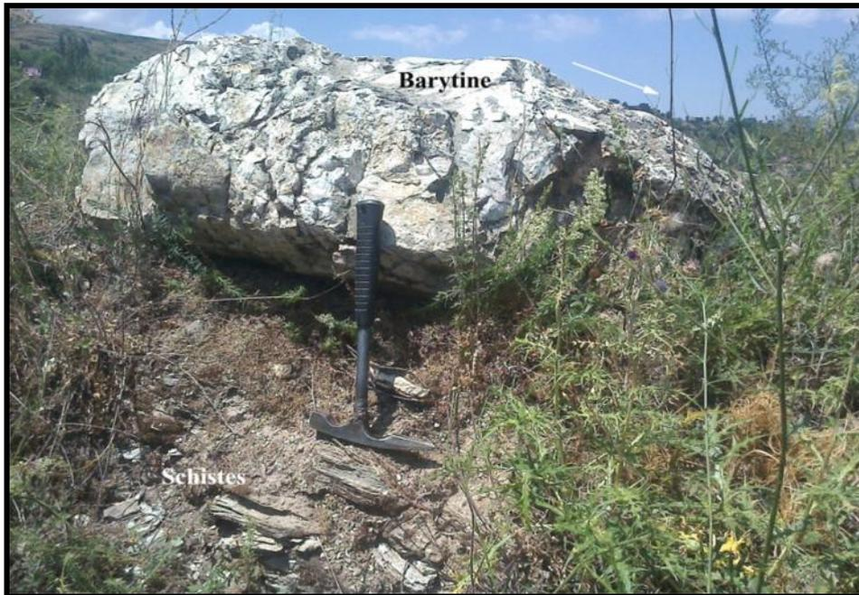
Figure V -1-B : Filon de barytine présentant un pendage relativement faible et parallèle à la schistosité.
