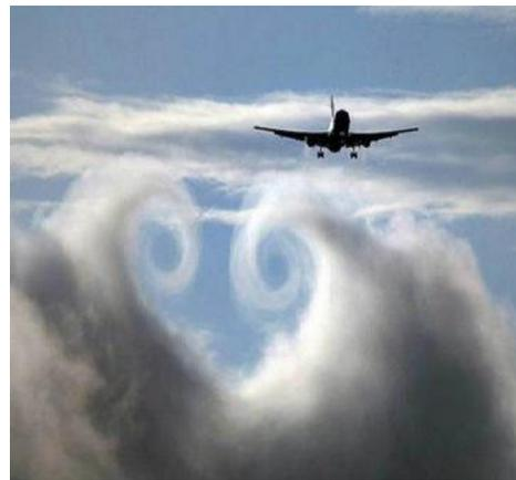
**Figure II.16 :** Trace des tourbillons marginaux dans l'air
