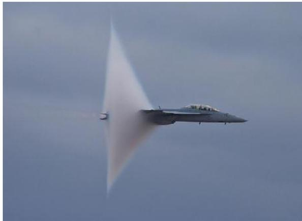
Figure II.14 :Onde de choc formée sur un avion de chasse
