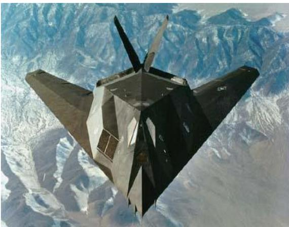
**Figure I -2 :** Le F-117 étant une aile delta simple
