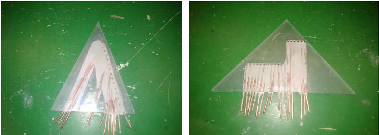
Figure III.8 : Maquettes réalisées avec des prises de pression
