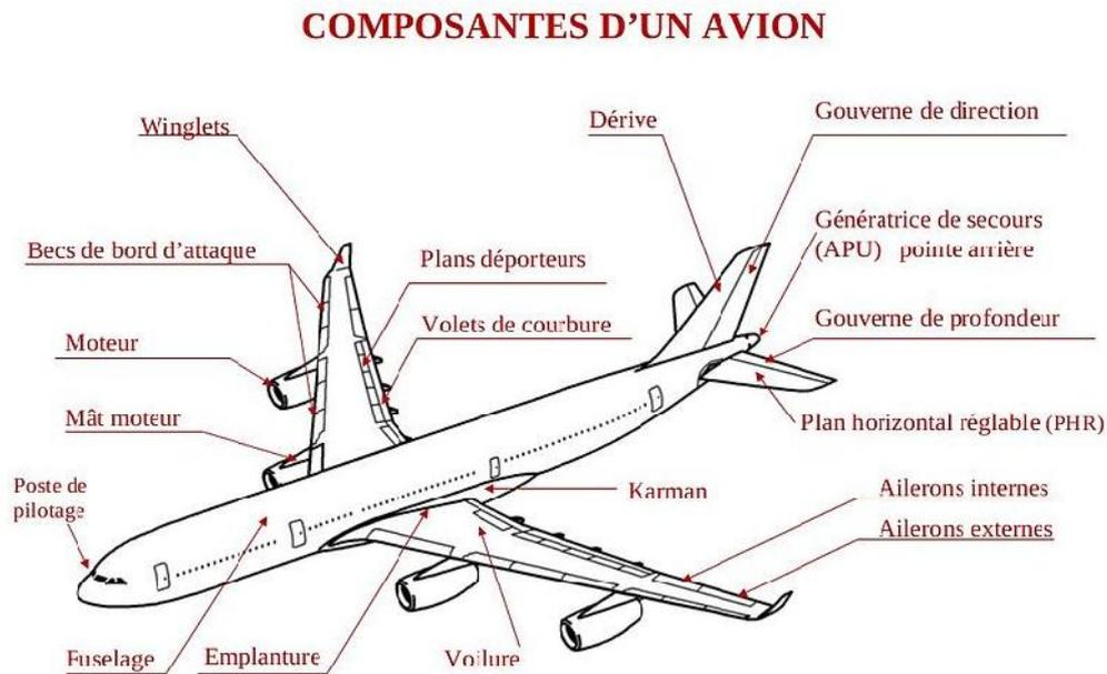
**Figure I-1 :**Composition d'un avion
