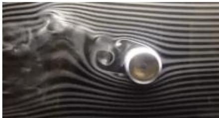
Figure II.14 :Effet Magnus sur un cylindre dans une soufflerie à fumées.
