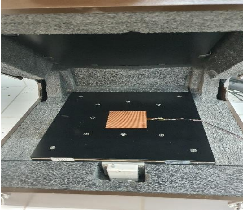
Figure 44 Association du CT-mètre et du fluxmètre dans l'installation expérimentale
