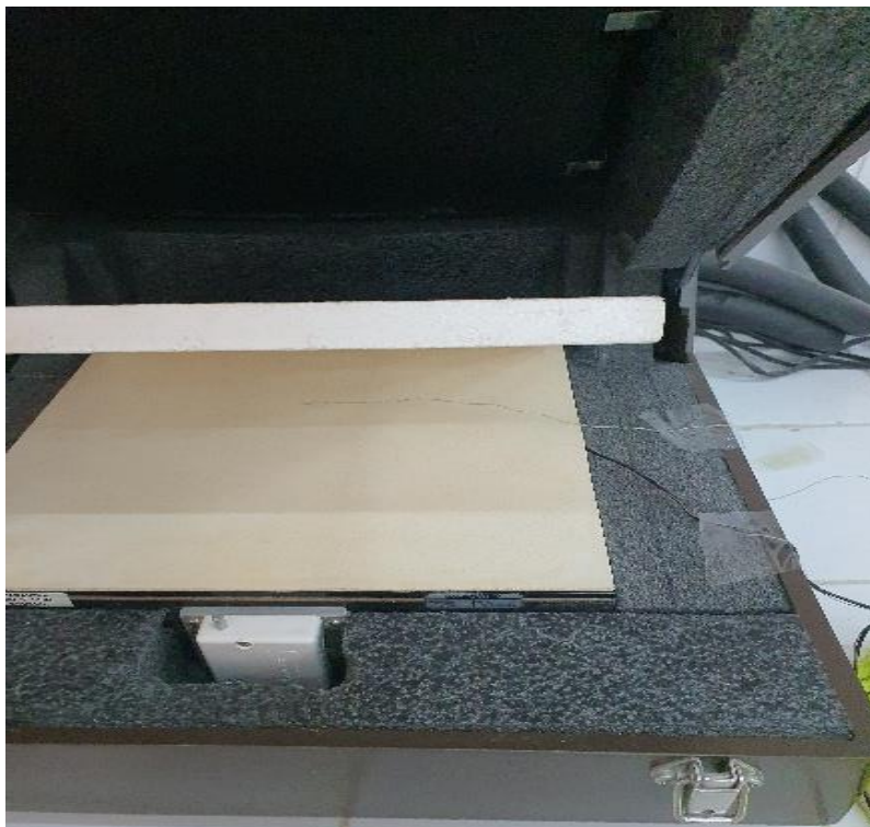
Figure 45 Mise en place de la plaque en caoutchouc et raccordement des thermocouples au CT-mètre
