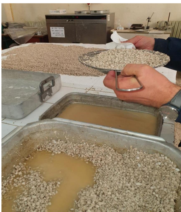
Figure 13 Imbibition de la sépiolite par plongée dans le MCP et égouttage du CLWA
