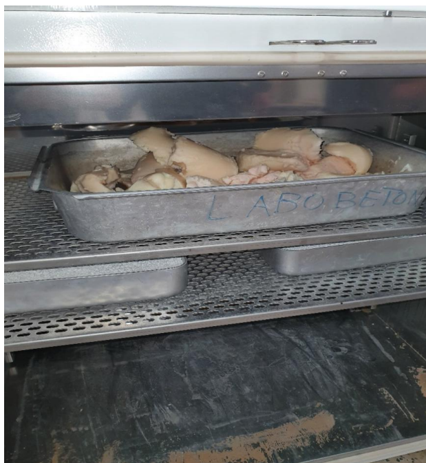
Figure 12 Mise à l'étuve à 60 °C des deux bacs, pour les opérations de fonte de la graisse végétale et séchage de la sépiolite.
