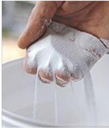
Figure 4 Image montrant des microcapsules de MCP (BASF)
