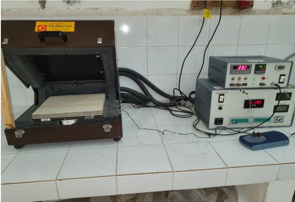
Figure 46 Mise en place d'une plaque pour la mesure de la conductivité avec le CT-mètre Hilton 112 et acquisition des données avec le PicoLog.
