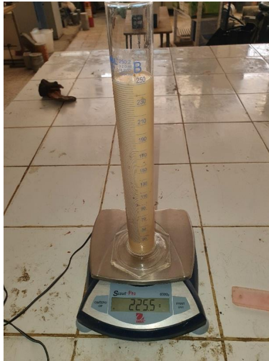
Figure 11 Mesure de la masse volumique de l'huile de coprah dans un b cher gradu 
