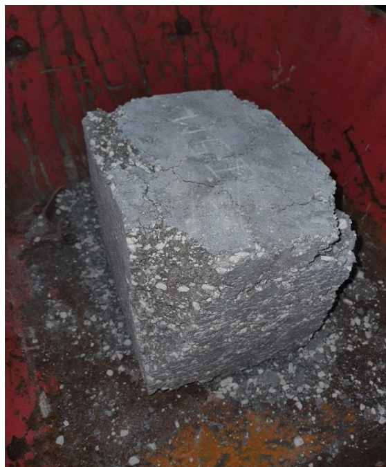
Figure 15 Bloc à 80 % de CLWA, exclu en raison de sa faible résistance mécanique
