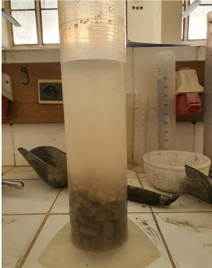
Figure 9 Mesure du volume d'un échantillon de gravier par immersion dans l'eau
