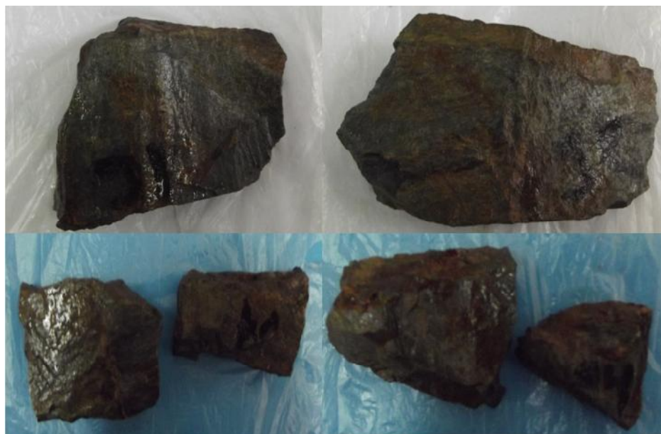
Figure VI-24: les grains de schiste a la fin de l'essai.
