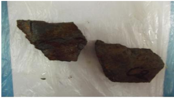
Figure VI-49 : grain de chlorure de sodium a la fin de l'essai
