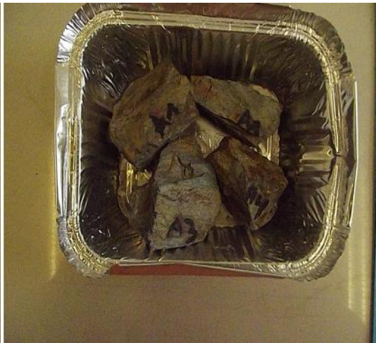
Figure VI-4 : grains séchés à l’étuve.
