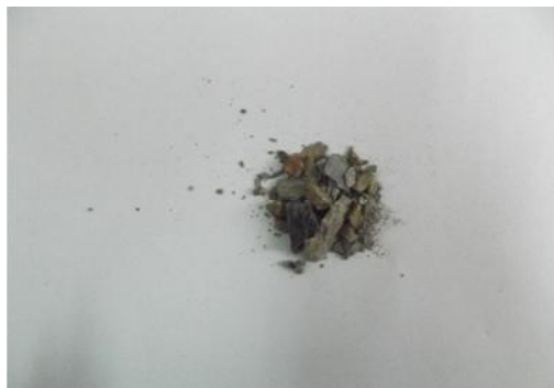
Figure VI-18 : les fines résultantes de l'essai gel dégel.
