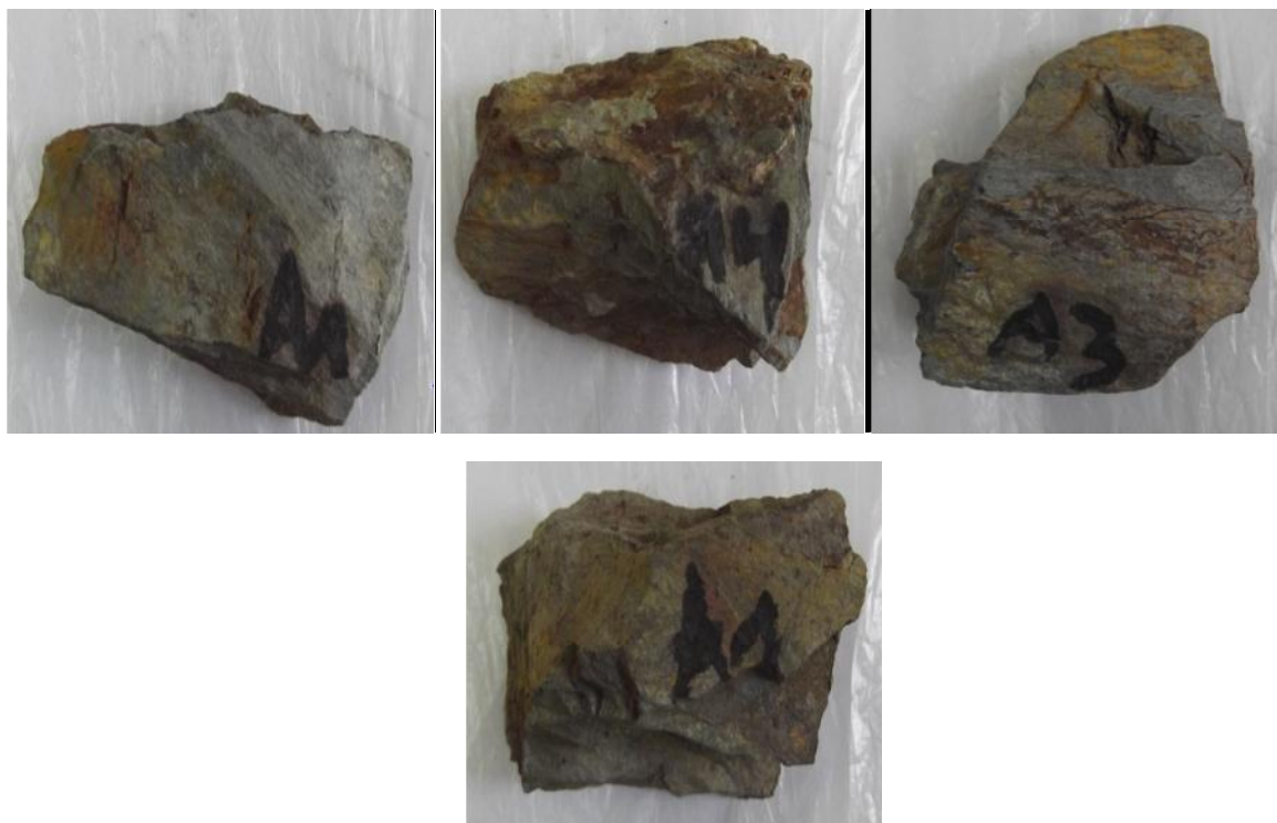
Figure VI-10 : les grains de schiste a la fin de l'essai.
