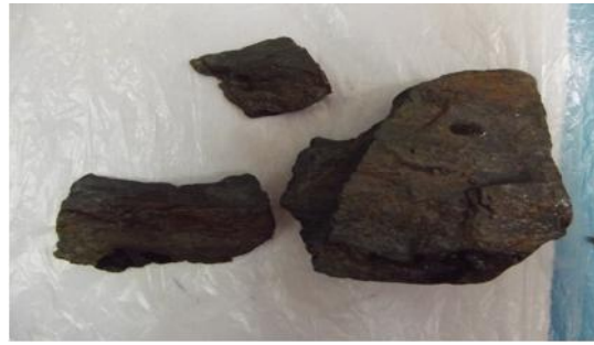
Figure VI-50 : grain de sulfate de magnésium a la fin de l'essai
