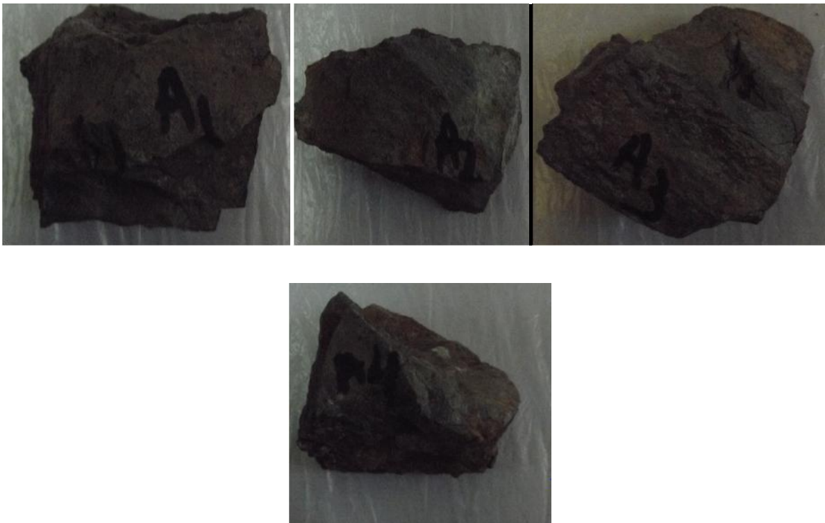
Figure VI-3 : les grains de schiste de l'essai altérabilité (LCPC) (grain1, grain2, grain3, grain4).
