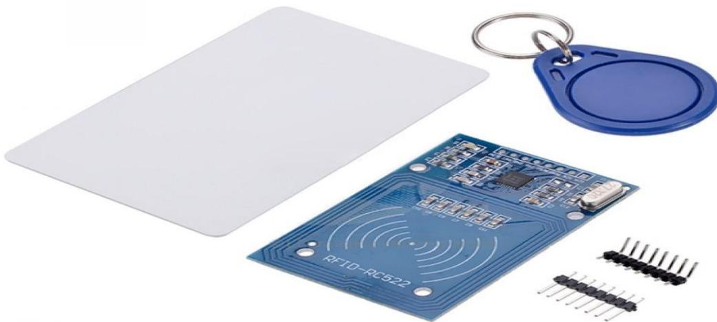
**Figure II-7 :** Mini-Plaquette RFID MIFARE RC522, carte puce et porte-clés
