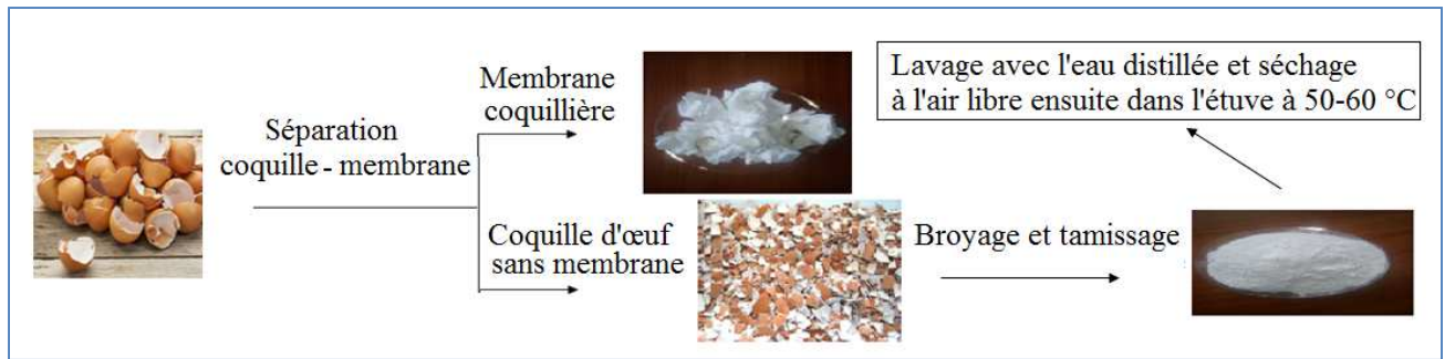
Figure.III.6. Etapes de préparation de l'adsorbant
