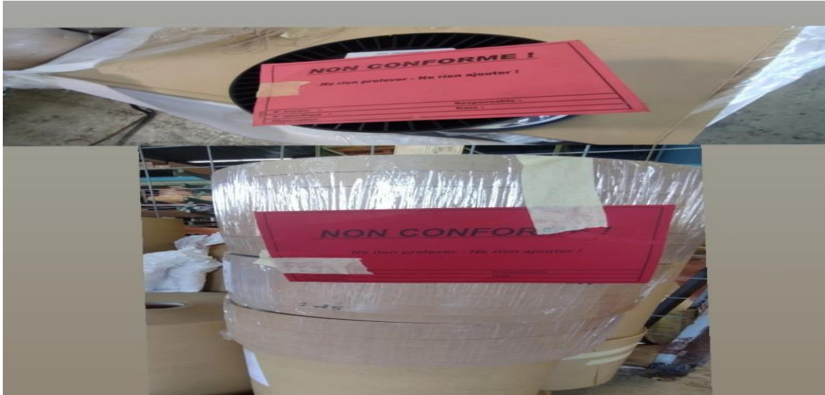
Figure 25 : Contrôle de matière première
