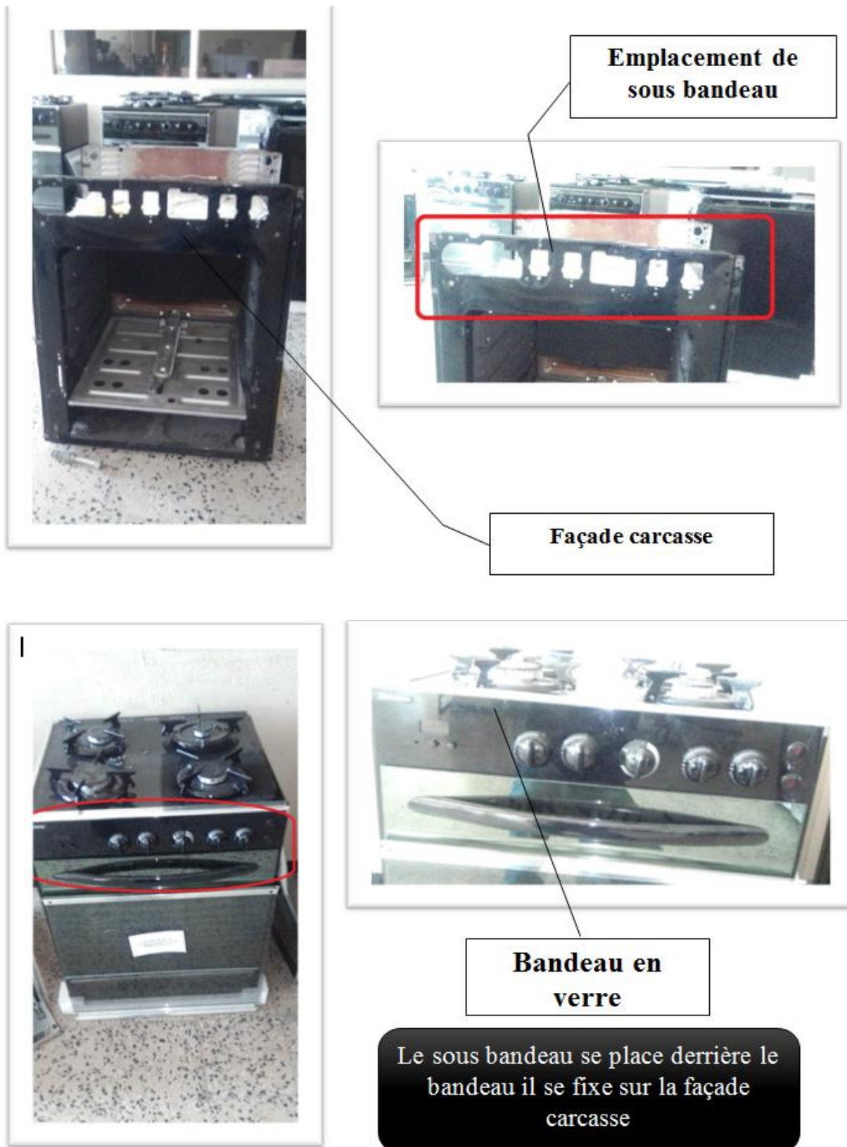
Figure IV-2 : Emplacement de la pièce
