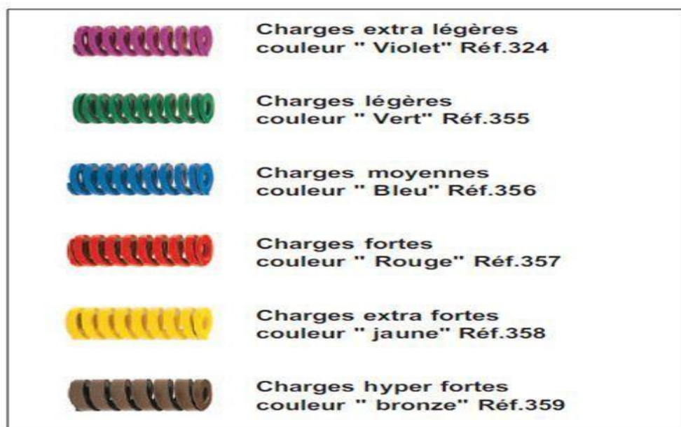
Figure IV-11 : Différents ressorts (représenter suivant ISO10243)
