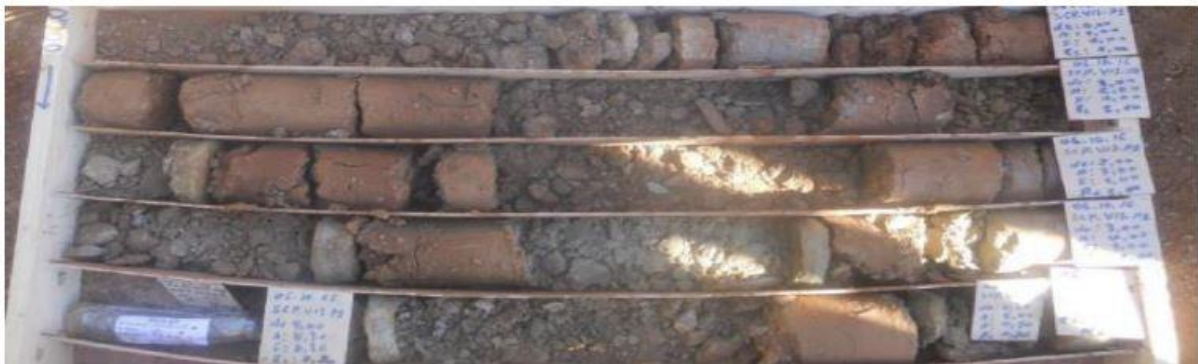
Figure 2.7 : Unité d'argile sablonneux et gravelé, généralement très solide/rigide, a plasticité faible/moyenne observée dans le sondage SCP-V13-P1
