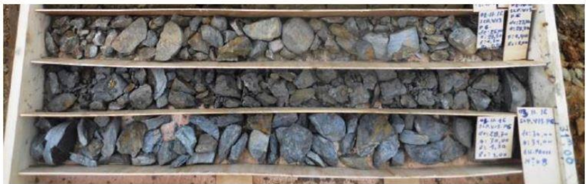
Figure 2.9 : Rochers méta clastiques, généralement des phyllites très/moyennement décomposées, a résistance très faible observés dans le sondage SCP-V13-P6.
