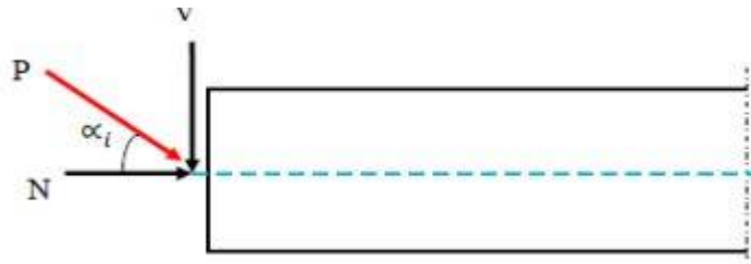
Figure 9.5: composantes de la force de précontrainte
