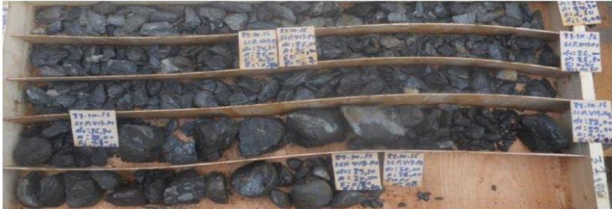
Figure 2.8 : Rochers méta clastiques, généralement des phyllites très/moyennement décomposées, à résistance très faible observés dans le sondage SCP-V13-P1.
