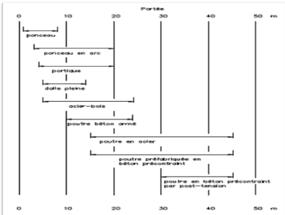
Figure2.11 : classification des ponts selon la portée.
