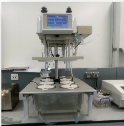
Figure 9 : Photo du « dissolutest » PTWS 820D
