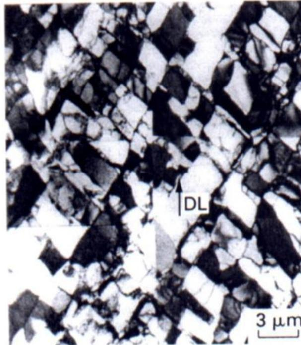
**Figure.II.6** : microstructure de dislocations observée au MET après laminage, la direction de laminage est DL [13]
