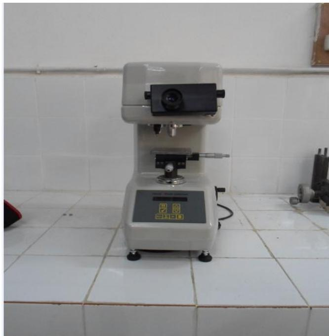
**Figure IV.9** : Schéma d'un MICRODUROMETRE de marque ZWICK
