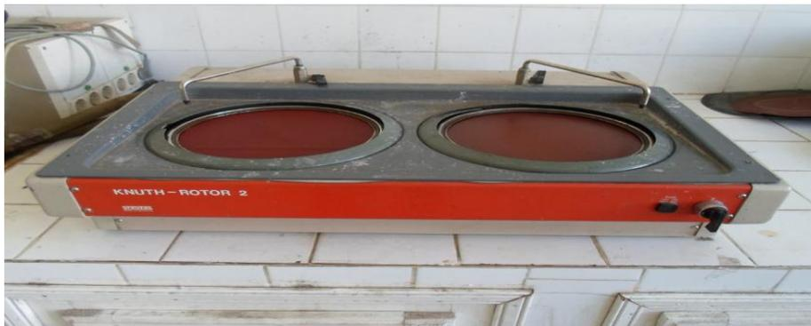
**Figure IV.1** : Polisseuse de types « STRUERS ».
