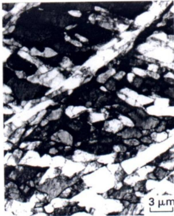
**Figure. II.8 :** Bandes de cisaillement, observées au MET, dans un monocristal d'aluminium [13]
