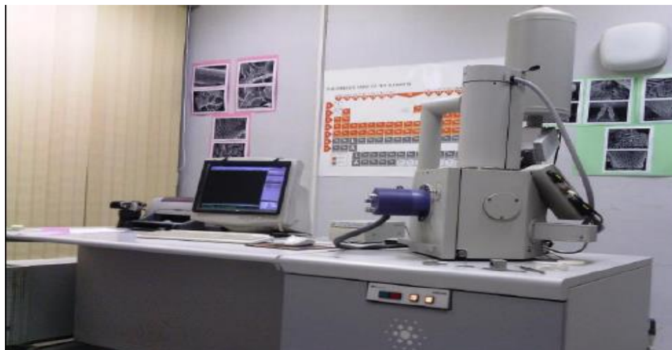
Figure II-11 : Microscope Electronique à Balayage de type Philips ESEM XL1.
