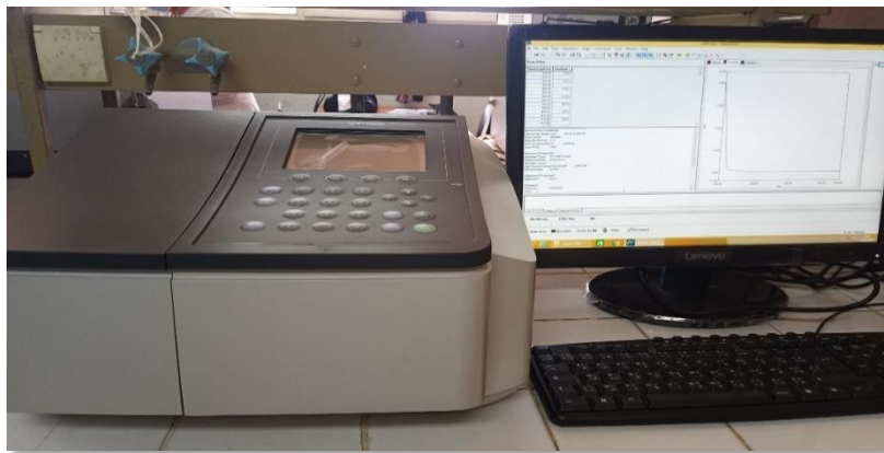
Figure II-10 : Spectrophotomètre UV-Visible de type SHIMADZU UV-1800
