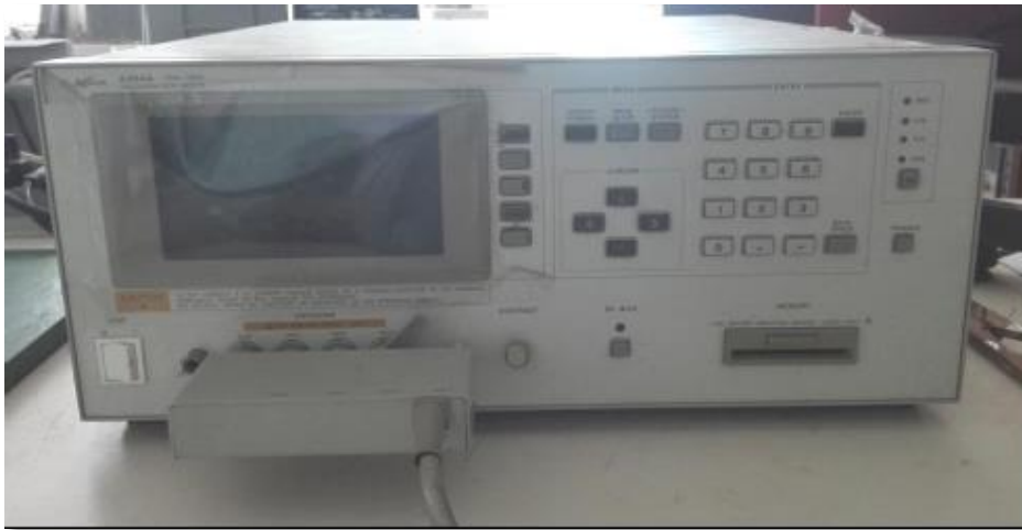
Figure II-12 : Impédancemètre de type HP 4284A.
