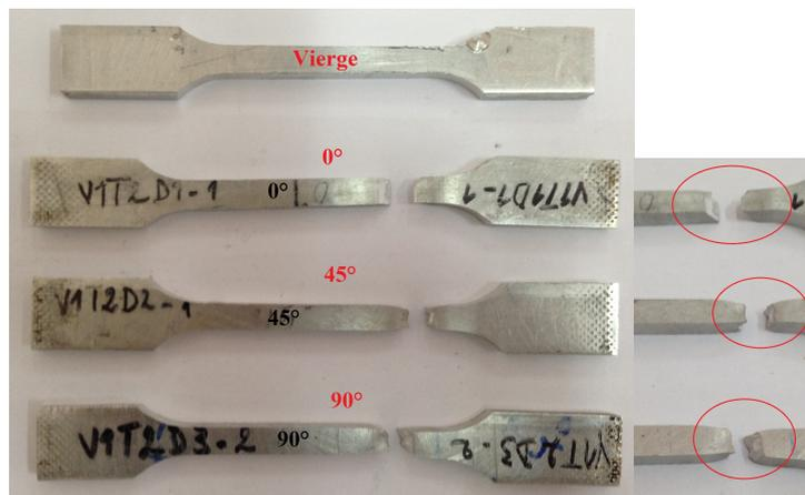
Figure 2.24 – Les éprouvettes avant et après déformation pour une vitesse de  $v=1 \text{ mm/min}$  selon les trois directions d'orthotropie dans le cas  $T=290^\circ$ .
