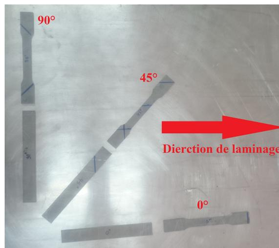
Figure 2.3 – Éprouvettes de traction prélevées selon les trois directions d'orthotropie par rapport à la direction de laminage.
