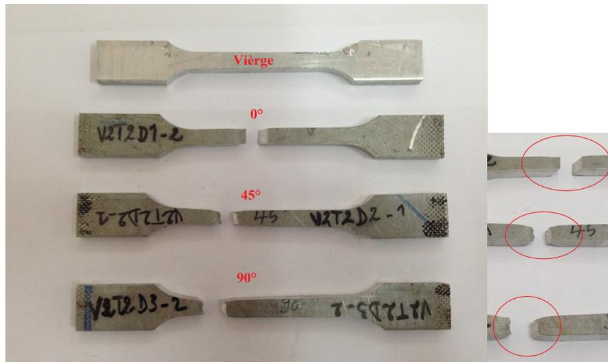
Figure 2.28 – Les éprouvettes avant et après déformation pour une vitesse de  $v = 10 \text{ mm}/\text{min}$  selon les trois directions de laminage à  $T=290^\circ$ .
