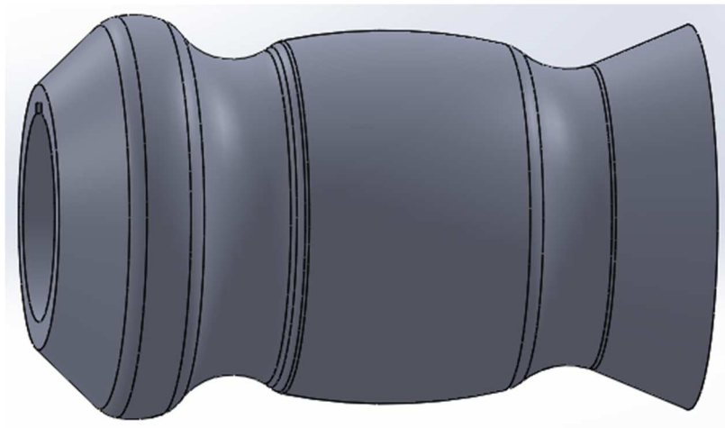
Figure II-3 : Conception d'un galet inférieur 1.
