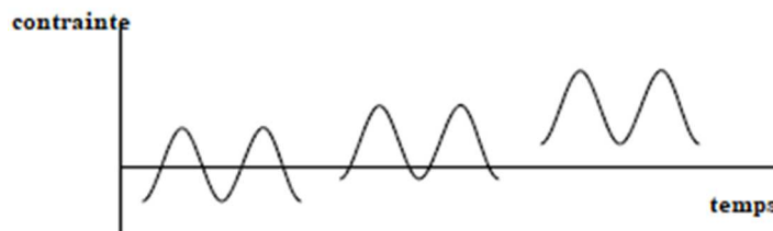
Figure IV-23 : Signaux d'essai à amplitude constante pour différentes contraintes moyennes.
