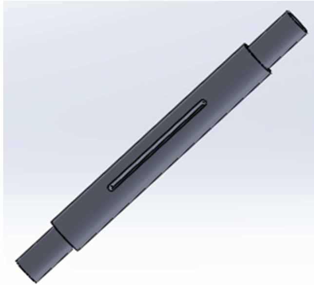
Figure II-20 : Conception d'un arbre supérieur.
