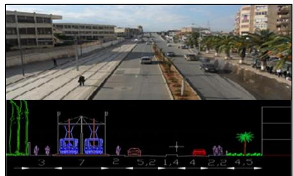
Figure 31 : Photo et coupe schématique de la RN05.
