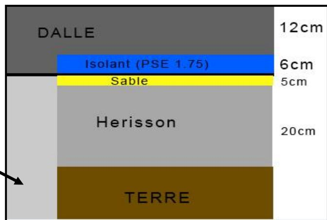
Figure 142 : Détails du dallage sur hérisson
