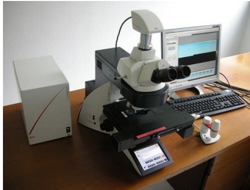
Figure 20 : Microscope optique avec platine automatisée et caméra numérique ( originale 2023 ).
